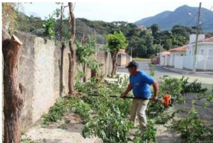
Figura 71: Motosserra com extensor.
